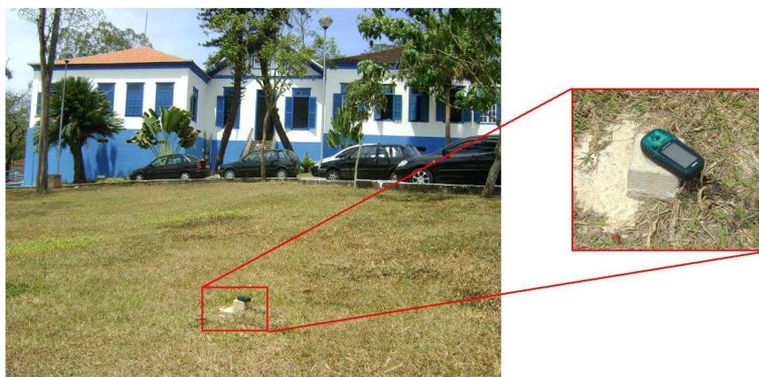
**FIGURA 1** – Receptor GPS Posicionado sobre Marco no IFRJ em Pinheiral-RJ
