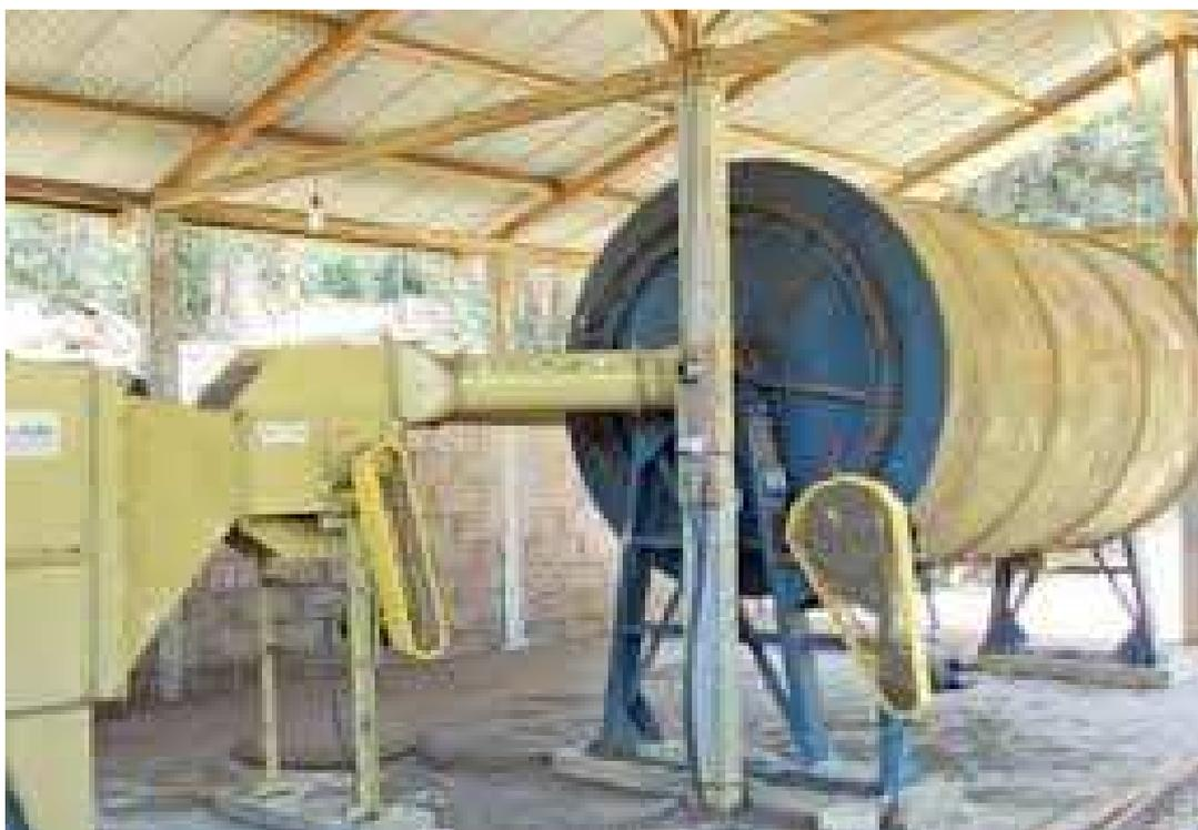
**FIGURA 2** – Modelo de secador mecânico rotativo a fogo direto
