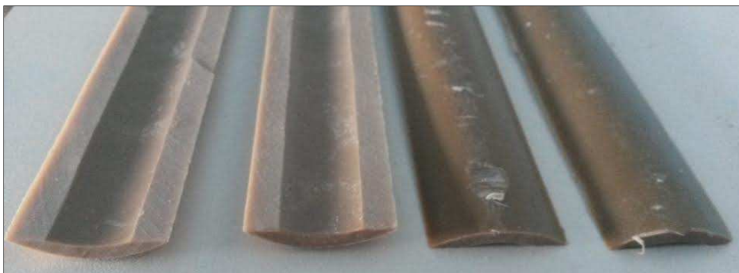
FIGURA 4 – Lâminas geradas via serra de bancada a partir do tubo de PVC.
