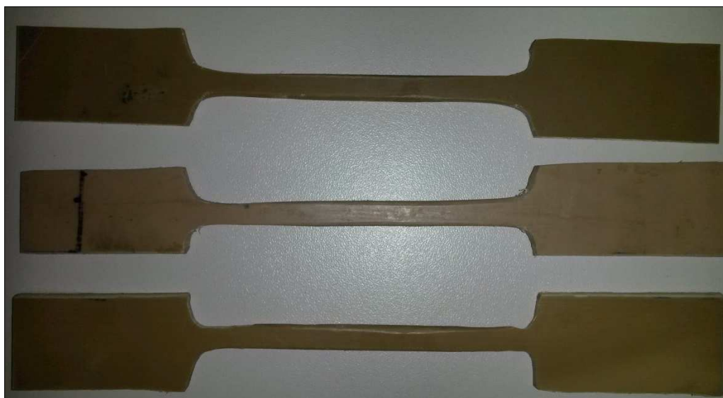
FIGURA 3 – Falta de Simetria nos corpos de prova obtidos de forma manual.
