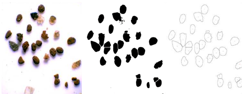
FIGURA 5 - Sequência padrão da análise granulométrica. Pré-tratamento; Aplicação do threshold; Analisador de diâmetro.
