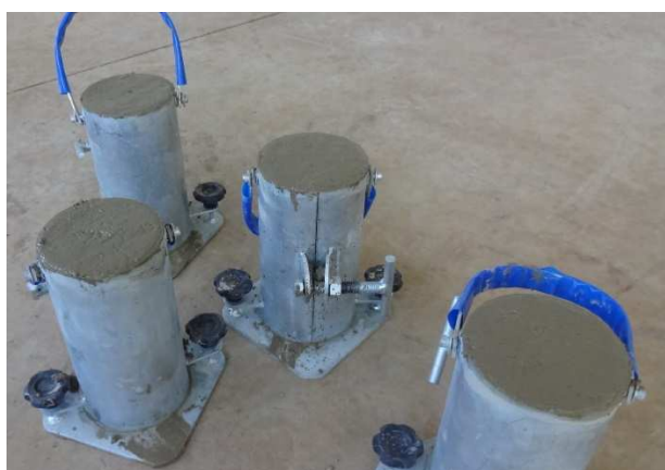
FIGURA 3 – Corpos de prova modelados nas fôrmas cilíndricas com suas superfícies acertadas (Fonte: Autoria própria).
