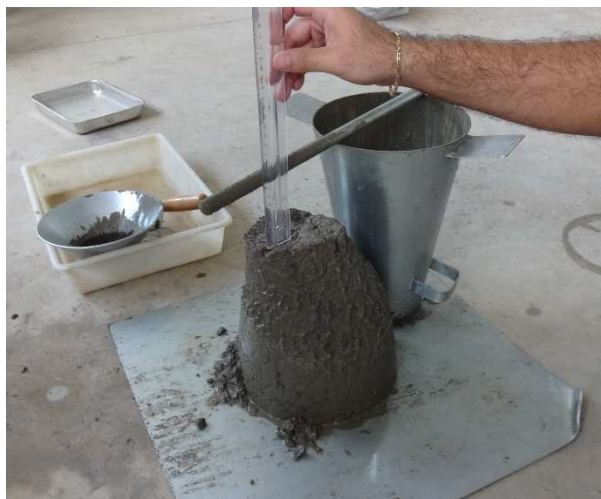
FIGURA 2 – Medida do abatimento do tronco de cone com o auxílio de uma régua milimetrada (Fonte: Autoria própria).
