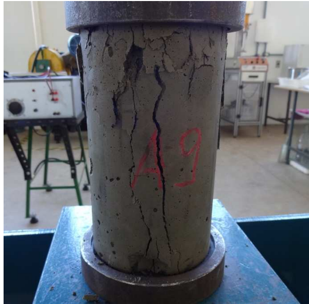
FIGURA 4 – Corpo de prova após ruptura em prensa hidráulica (Fonte: Autoria própria).
