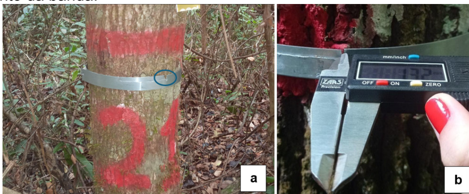
FIGURA 3. Banda dendrométrica a) círculo azul indicando a janela de crescimento formanda com a sobreposição das extremidades da banda; b) medição da janela de crescimento da banda.
