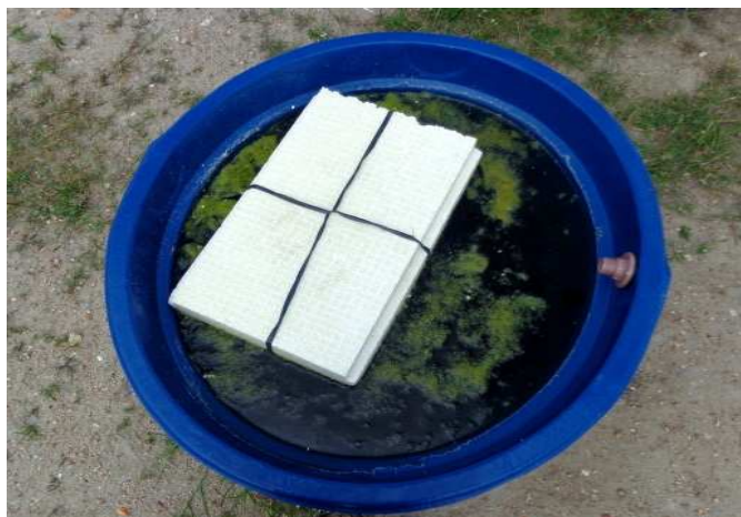
FIGURA 5: Tanque com cobertura de EPS (T 3 ) (Fonte: arquivo pessoal)
