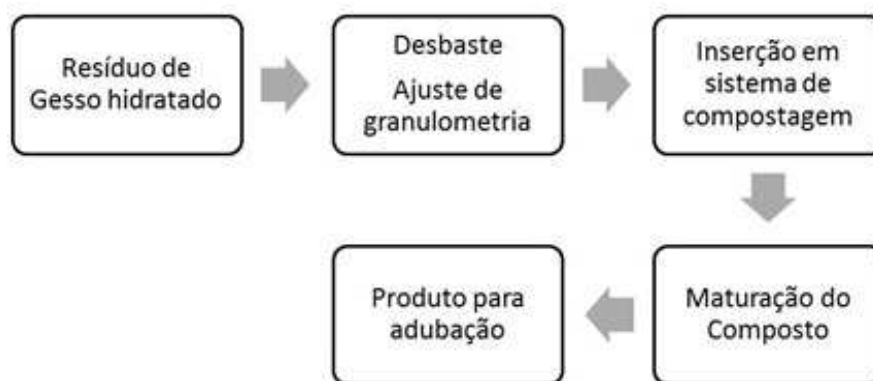
FIGURA 5 – Sistema de aproveitamento de gesso em processo de compostagem. Fonte: BUONO et al. (2013).
