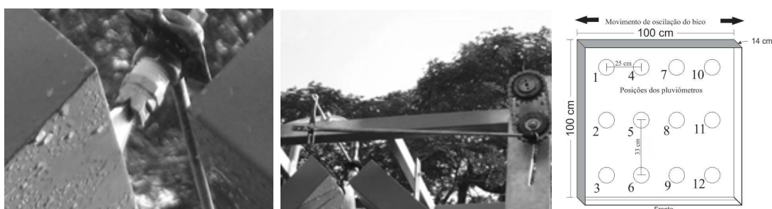
FIGURA 2: Detalhe do bico aspersor, (b) Sistema mecânico e (c) croqui da parcela.
