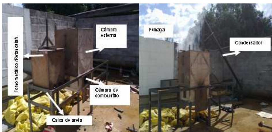
FIGURA 3 – Equipamento completo (forno + condensador)
