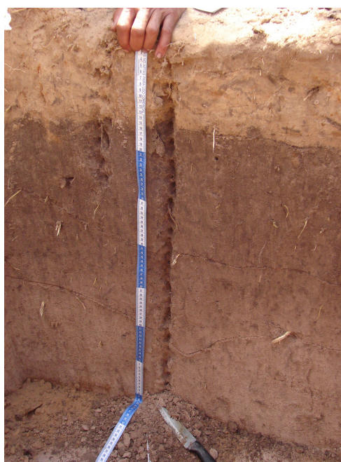
FIGURA 1. Trincheira aberta na cabeceira do pasto para descrição morfológica do perfil de solo. Fonte: CORRECHEL, (2008).
